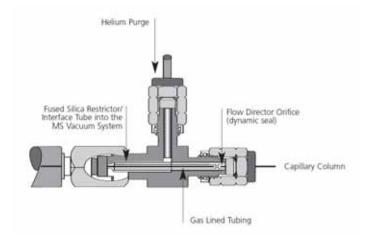
В рабочем состоянии поток гелия отключен, прибор работает в обычном режиме.
