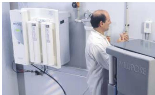
Все модули очистки воды, узлы мониторинга качества воды на каждой ступени и узел управления расположены в одном блоке прибора. Модульная конструкция позволяет легко переоснащать систему RiOs для изменившихся условий эксплуатации. После установки дополнительных узлов система может производить воду аналитического качества. Возможно также и увеличение производительности системы.
